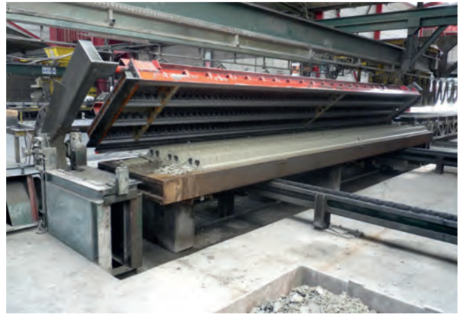
Instalación de carrusel para las placas alveolares
