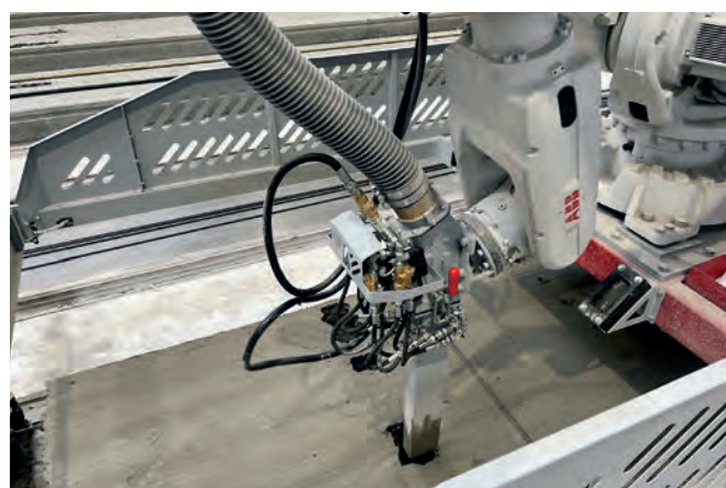
La nueva aspiradora de hormigón automática desarrollada por Nordimpianti para la fábrica de Tessenderlo
