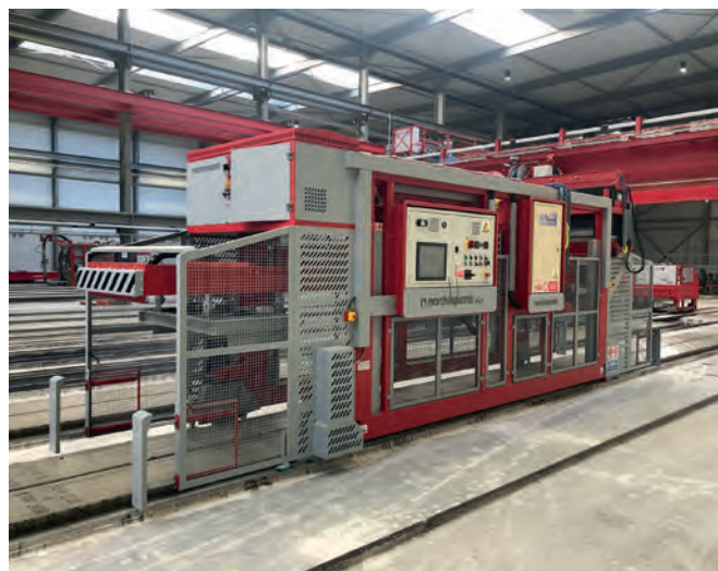
Elevación de placas alveolares pretensadas con la nueva máquina apiladora desarrollada por Nordimpianti
