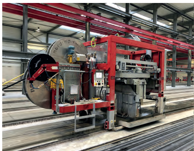
Máquina cortadora automática de ángulo regulable de Nordimpianti
