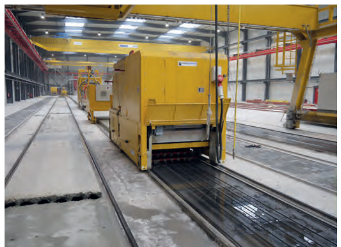
Extrusora durante el hormigonado de placas alveolares pretensadas en la fábrica de Malle
