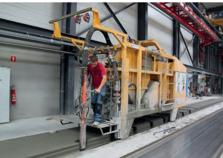
Funcionamiento manual de una aspiradora de hormigón en la fábrica de Malle
